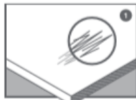
Oberflächliche Schäden durch Mikrokratzern.
