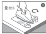
Das aufgewärmte Bügeleisen auf der Fläche positionieren, die repariert werden muss. Das Bügeleisen nicht länger als 10 Sekunden auf der Oberfläche belassen.
